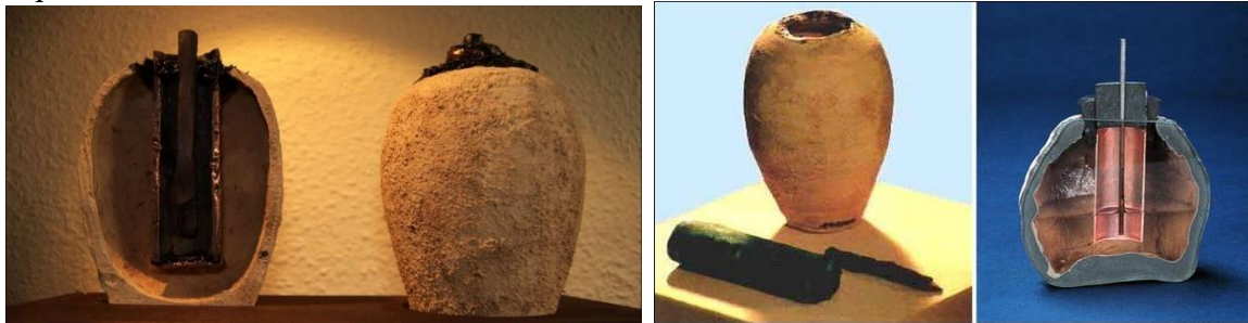
2.4-сурет. Біздің заманымыздан бұрын 500 жыл шамасында парсылар ойлап тапқан алғашқы батарея құрылғысының фотосуреттері. [2].
