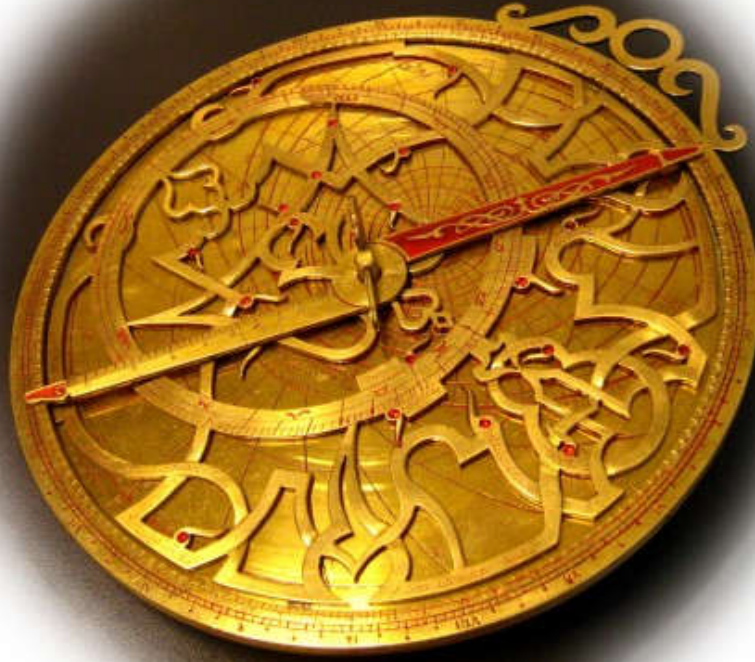
Рисунок 11.4. Фотография астролябии, которую Бируни использовал для измерения углов \theta_1 и \theta_2 на рисунке 11.3.
